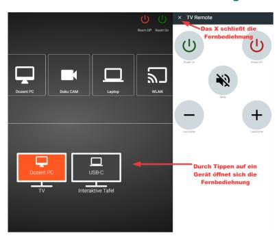
Das Touchdisplay ist zugleich die Fernbedienung der Geräte. Die Fernbedienung lässt sich mit einem Tippen öffnen. Die Tasten variieren dabei je nach gerät und Funktionalität.
